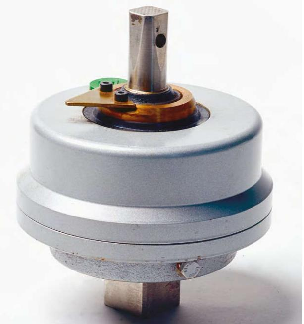
Umrüstung von Armaturen von Stopfbuchsen- auf O-Ring-Dichtung und Polyamid- auf Messingbuchse
